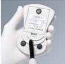
Eine Schablone auf der Rückseite des Gehäuses dient der Bestimmung des Durchmessers kreisrunder Lichtleiter.
